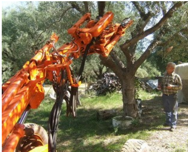
Συλλογή ελιών με μηχανοκίνητο δονητή κορμού.
