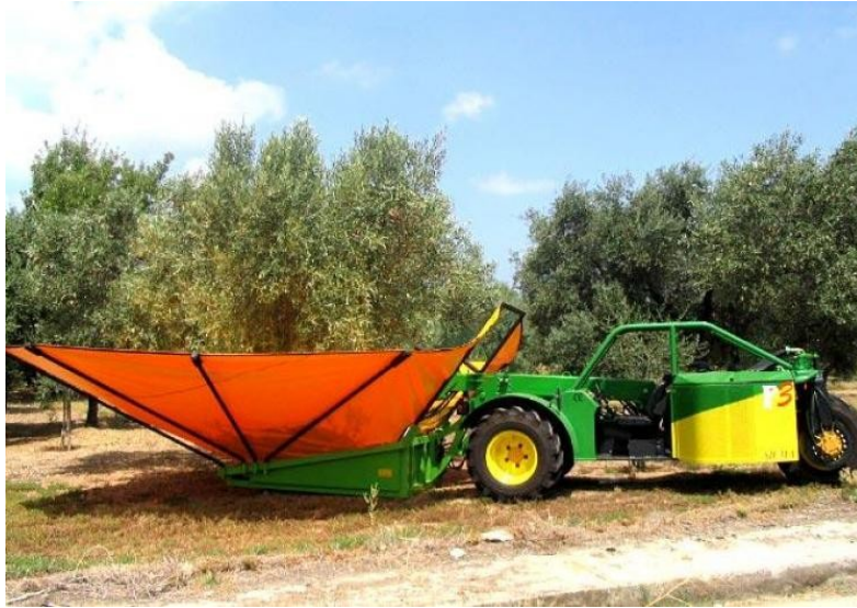
Αυτοκινούμενος δονητής κορμού και ελαιοσυλλέκτης
